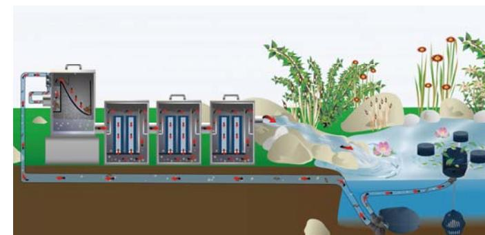
Filtersystemet kan placeres over dam vandstand. Gennem en pumpe (eller en nivelleret FIAP Pump Aktiv) beskyttet dam vand bliver transporteret ind i filtersystemet. Den allerede renset vand løber tilbage i dammen i løbet af en slange med en tilbagegang.
