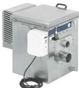
Sercem filtru jest bezobsługowy z łatwo wymiennymi elementami TrommelSieve (60 mikronów) oraz cyfrowe sterowanie. (FIAP Obsługi TrommelSieve Active)
