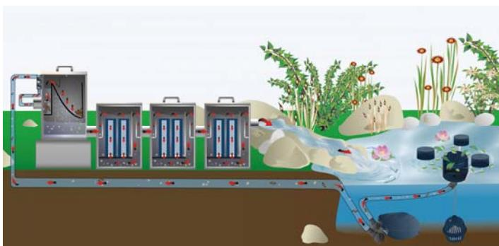
Filtersystemet kan placeras ovanför dammen vattennivån. Genom en pump (eller en planade FIAP Pump Aktiv) dirty vatten transportereras in i filtersystemet. Den redan renade vattnet rinner tillbaka till dammen över ett rör med en nedgång.
