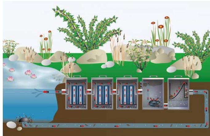
Filtre sistemi tamamen zemine inşa edilmiştir. Katta drenaj üzerinde kirli su birikintisi su yerçekimi neden olduğu ilk filtre modülü, ularır. Pompa sisteminin sonuna yerleştirilmiş pompa odası içinde yer almaktadır. Bu havuzatınız su geri taşır.
