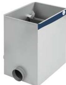
Il filo cuneo FIAP è utilizzato per la purificazione meccanica e larga scala di stagno acqua inquinata. Dai solidi cuneo integrate vengono rimossi fino a una dimensioni di 300 micron. Congiuntamente dalle "colonne" dell'acqua è il ciclo dell'acqua è arricchita con ossigeno, e serve quindi come ottimale prefiltraggio per il processo biologico.
