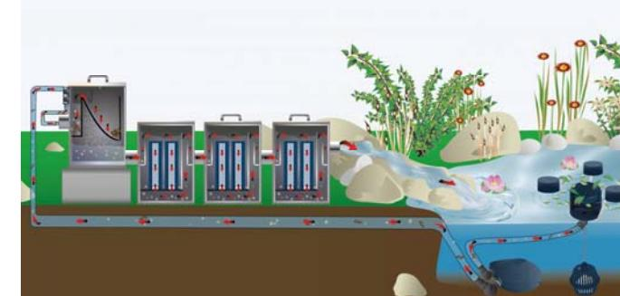
Il sistema di filtro può essere posizionato sopra il livello dell'acqua del laghetto. Attraverso una pompa (o di una pompa di FIAP attiva livellata) acqua del laghetto sporco viene trasportato nel sistema di filtraggio. L'acqua già pulita corre di nuovo nello stagno su un tubo con un declino.
