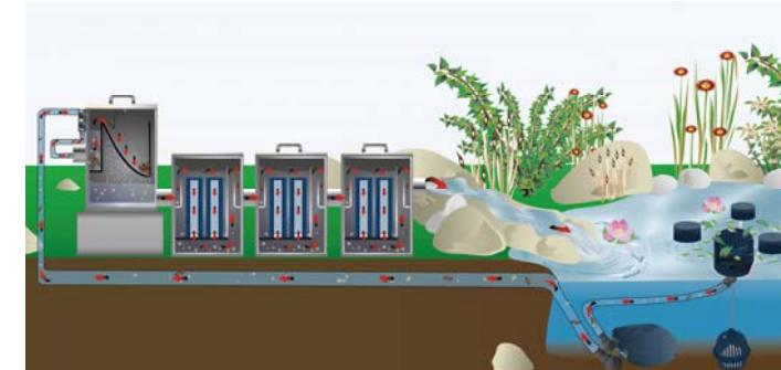
Suodatin -järjestelmä voidaan sijoittaa edellä lampi veden tasolla. Pumpun kautta (taitasoitettu FIAP Pump Active) likaisen lampi vesi kulkeutuu suodattimen avulla. Jo puhdistettu vesi valuu takaisin altaaseen yliputkilaskuun.
