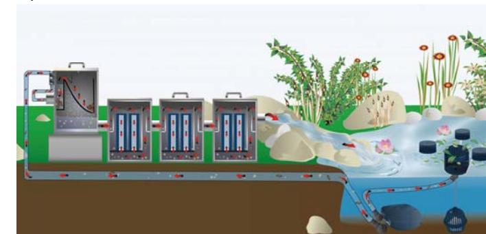
Филърът може да бъде поставена над нивото на водата в езерцето. Чрез помпа (или изравната FIAP Помпа Active) мръсната езерна вода се транспортира във филърната система. Вече почистват водата тече обратно в езерото през една тръба със спад.
