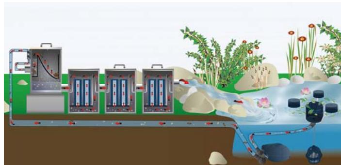
Система фильтра может быть размещен выше уровня воды в пруду. Через насос (или насос выровняли FIAP Активный) грязной воде пруда транспортируется в фильтре системы. Уже очищенная вода бежит обратно в пруд на трубку со снижения.
