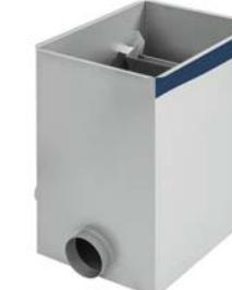
Der FIAP Spalt Active dient zur mechanischen und großflächigen Reinigung des verschmutzten Teichwassers. Durch das integrierte Spaltsieb werden Feststoffe bis zu einer Größe von 300 Mikron entfernt.
