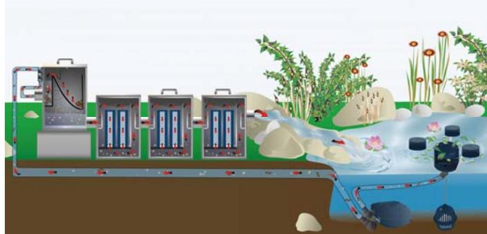
El sistema de filtración se puede colocar sobre el nivel del agua del estanque. A través de una bomba (o un FIAP Bomba activo estabilizado) estanque de agua sucia se transporta en el sistema de filtro. El agua ya limpia vuelve corriendo en el estanque en un tubo con una disminución.
