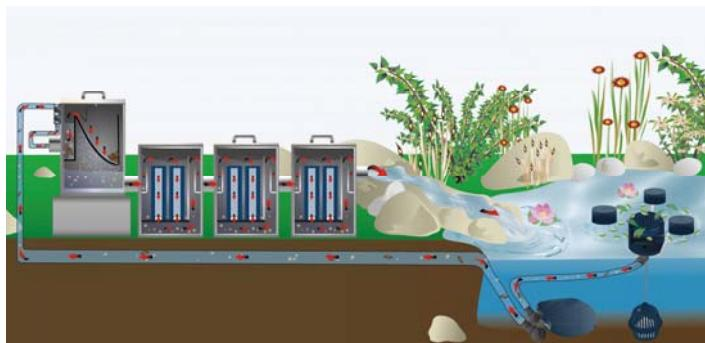
Filtre sistemi gölet su seviyesinin üzerinde yerleştirilebilir. Bir pompa (veya tesviye FIAP Pompa Aktif) kirli havuz suyufiltre sistemi içine taşınır. Sayesinde Zaten temizlenmiş su bir düşüş ile bir tüp içinde gerihausa çalışır.
