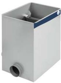
Het FIAP wig draad wordt gebruikt voor de mechanische en grootschalige zuivering van vervuild vijverwater. Door de geïntegreerde Wedge vaste stoffen worden verwijderd tot een grootte van 300 micron. Daarnaast is door de "kolommen" van het water wordt de waterkringloop is verricht met zuurstof, en dus dient als de optimale pre-filtering voor het biologisch proces.
