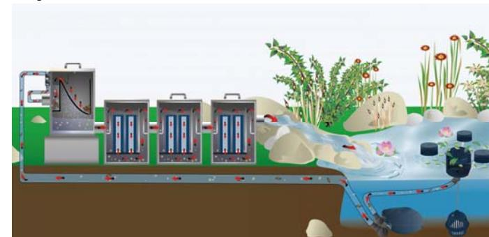
Het filtersysteem kan boven vijverwater niveau worden geplaatst. Door middel van een pomp (of een waterpas FIAP Pomp Actief) vervuiled vijverwater wordt getransporteerd in het filtersysteem. De gereinigde water loopt terug in de vijver op een buis met een daling.
