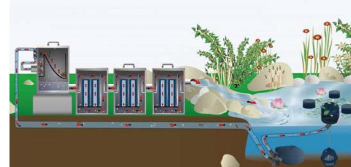
O sistema de filtro pode ser colocado acima do nível de água da lagoa. Através de uma bomba (ou uma bomba nivelado FIAP Activo) sujo água da lagoa é transportado para dentro do sistema de filtro. A água já limpos corre de volta para o tanque ao longo de um tubo com um declínio.
