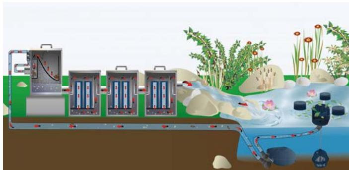
Das Filtersystem kann oberhalb des Teichwasserspiegels stehen. Verschmutztes Teichwasser wird mit einer Pumpe aus dem Teich (oder aus der einnivellierten FIAP Pump Active) in das Filtersystem gespeist. Das gereinigte Wasser fließt über eine Rohrleitung im freien Gefälle in den Teich zurück.
