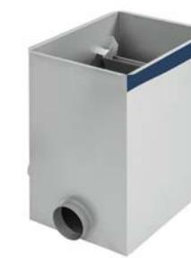
Το σύρμα σφήνα FIAP χρησιμοποιείται για τη μηχανική και την μεγάλης κλίμακας καθαρισμό των μολυσμένων υδάτων λίμνης. Με τα ολοκληρωμένα στερεά Σφήνα αφαιρεθεί μέχρι ένα μεγέθους 300 microns. Επιπρόσθετα από τις στήλες του νερού είναι ο κύκλος του νερού είναι εμπλουτισμένο με οξυγόνο, και ως εκ τούτου χρησιμεύει ως το βέλτιστο προ- φίλτραρισμά για τη βιολογική διαδικασία.
