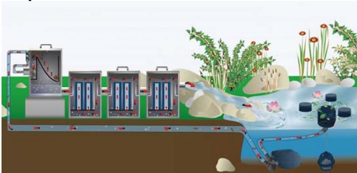
A szűrőrendszer lehet helyezni tóval felett vízszint. Egy szivattyú (vagy a leveled FIAP szivattyú Active) szennyezett tó vizét szállítja a szűrőrendszer. A már megtisztított víz folyik vissza a tóba egy cső a visszaesés.
