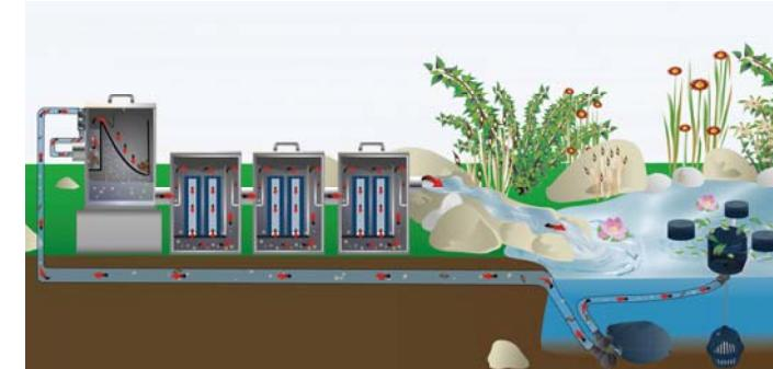
Система фільтра може бути розміщений вище рівня води у ставку. Через насос (або насос вирівняли FIAP Активний) брудної воді ставка транспортується у фільтр системи. Вже очищена вода відходить назад у ставок на трубку зі зниження.
