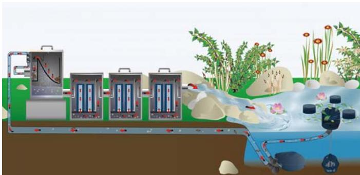
Le système de filtration peut être placée au-dessus du niveau d'eau de l'étang. Grâce à une pompe (ou une pompe FIAP nivé Active) l'eau de l'étang sale est transporté dans le système de filtration. L'eau déjà nettoyé retourne dans le bassin au cours d'un tube avec une baisse.
