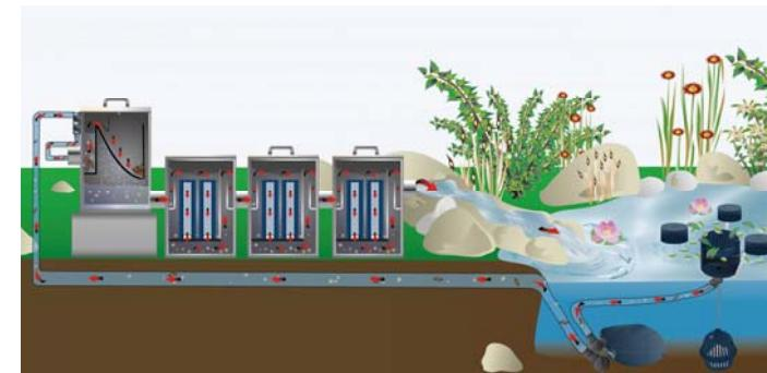
Filtracní systém může být umístěn nad hladinou vody v jezírkách. Pomocí čerpadla (nebo vyrovnat FIAP čerpadlo Active) znečištěná voda rybník je transportována do filtracního systému. Již vycvičená voda běží zpět do rybníka přes trubku s poklesem.
