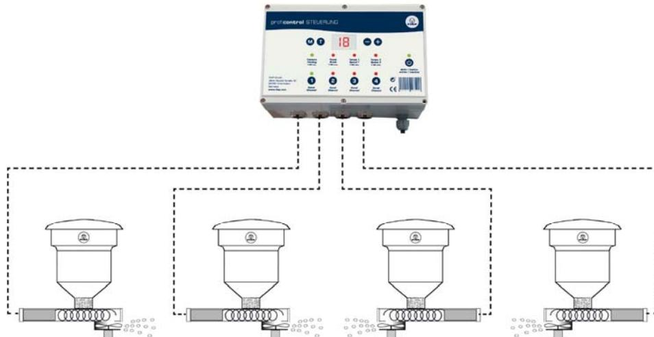
Os botões do controlador pode controlar FIAP beneficiar o tempo de execução em segundos (1 - 99). O tempo de espera em minutos (1-99) ea velocidade do motor pode ser ajustada em 99 passos para cada saída. O total de lucro controle controle FIAP pode ser através de um botão separado ligado ou desligado. As configurações são mantidas após um reset (power off) é obtido.
