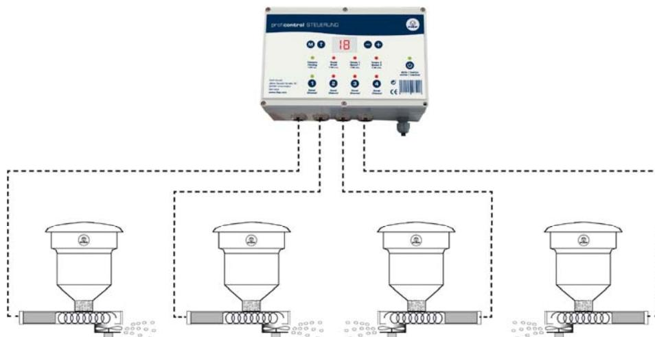
Butoanele de pe controller poate controla FIAP beneficia de timpul de execuție în secunde (1 - 99). Așteptați timp în minute (1-99) și viteza motorului poate fi ajustată în 99 de pași pentru fiecare ieșire. Totală a profitului de control de control al FIAP poate fi prin intermediul unui buton separat on sau off. Setările sunt reținute după un reset (off), se obține.
