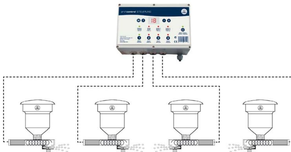
Über die Tasten an der FIAP proficontrol Steuerung kann die Laufzeit in Sekunden (1 - 99), Pausenzeit in Minuten (1 - 99) und die Motordrehzahl in 99 Stufen für jeden Ausgang eingestellt werden. Die gesamte FIAP proficontrol Steuerung kann über eine separate Taste aktiviert oder deaktiviert werden. Die Einstellungen bleiben nach dem Reset (Ausschalten) erhalten.
