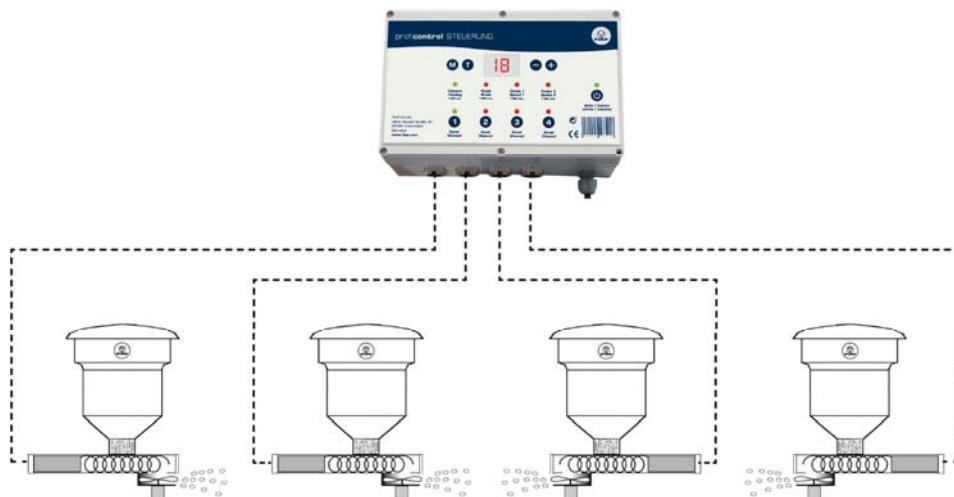
Denetleyicisinde düğmeleri FIAP yarar saniye olarak çalışma süresi (1 - 99) kontrol edebilirsiniz. Dakika süre (1 - 99) bekleyin ve motor hızı her çıkış için 99 adımda ayarlanabilir. Toplam kar kontrolü FIAP kontrolü açık veya kapalı ayrı bir düğme ile olabilir. Bir reset (güç kapalı) alındıktan sonra ayarları korunur.
