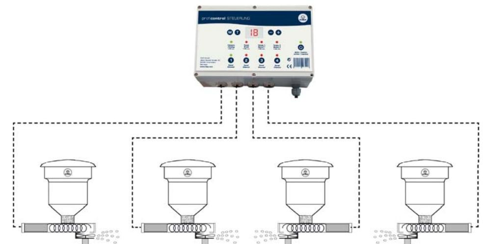
De knoppen op de controller kan besturen FIAP ten goede aan de lopende tijd in seconden (1 - 99) Wacht tijd in minuten (1-99) en de snelheid van de motor kan worden ingesteld in 99 stappen voor elke uitgang. De totale winst controle FIAP controle kan worden via een aparte knop aan of uit. De instellingen blijft behouden na een reset (power off) wordt verkregen.
